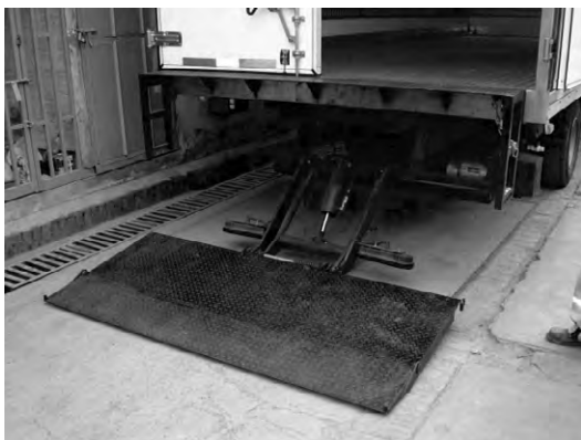
Plataforma hidráulica de cargue
