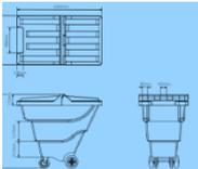
Capacidad 1600 litros, capacidad de carga de 700 kg, arrumables sin tapa para facilitar manejo, facilidad de descargue, pestaña reforzada resistente al impacto, ruedas anti pinchazos y silenciosas.
