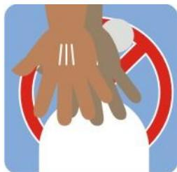
Nunca cuelgue herramientas, guantes, ropa o encendedores de chispa encima del cilindro. Éstos pueden interferir con la operación de la válvula y obstaculizar el cierre rápido del gas en caso de emergencia.
