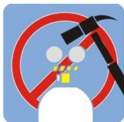
Nunca martille, fuerce o apalanque una válvula de cilindro atascada o congelada, ni use una llave de expansión para aflojarla. Si no se puede abrir manualmente, llame a su proveedor.
