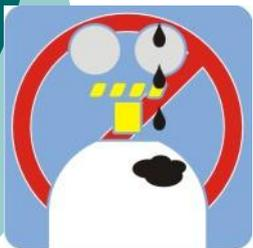
No permita que la grasa, el aceite u otros materiales combustibles entren en contacto con cualquier parte del cilindro, en especial con el oxígeno. La grasa o el aceite se oxidan muy lentamente con el aire y estallan en llamas ante el oxígeno puro.
