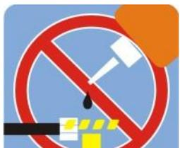
Nunca engrase o lubrique con aceite, reguladores, mangueras, válvulas de cilindros o cualquier cosa que vaya a estar en contacto con oxígeno.
