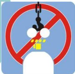
Nunca levante un cilindro por la válvula o por su tapa, ni con soportes, cadenas, o magnetos.
