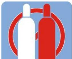
No almacene cilindros de gases medicinales junto con otros gases.
