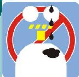
No coloque los cilindros de oxígeno ni el equipo en lugares donde les pueda caer grasa o aceite de las máquinas.
