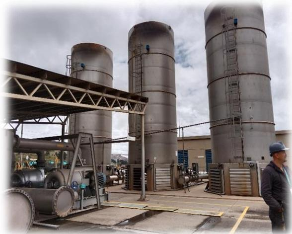
Combustión del Biogás, realizado a través de las 3 antorchas que se aprecian en la fotografía
