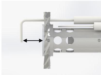
Revise el estado de las galgas de inyección de aire en el distribuidor de admisión y descarga del ventilador central, verifique su posición y medida.
