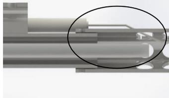
Ubique la punta de los electrodos de chispa frente a la boquilla piloto por encima de la línea de aspersion a 3mm aproximadamente.
